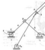
Figura 1.9: Diagrama cinemático equivalente, croquis, de la fig. 1.4
